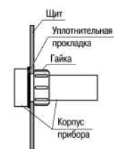
Рисунок 3 – Монтаж прибора щитового крепления
