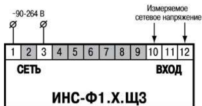
Рисунок 6 – Назначение клеммника прибора модификации ЩЗ
