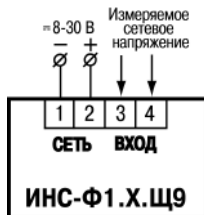
Рисунок 7 – Назначение клеммника прибора модификации Щ9
